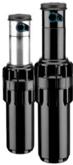
I-25-04 Загальна висота: 20 см Висота підняття: 10 см Зовнішній діаметр: 5 см Розмір вхідного отвору: 1" (25 мм) (BSP)
